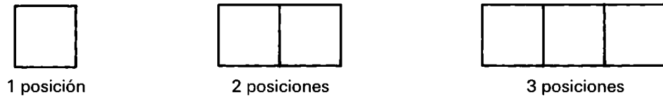
Fig. 6.1. Representación de las posiciones de una válvula.
